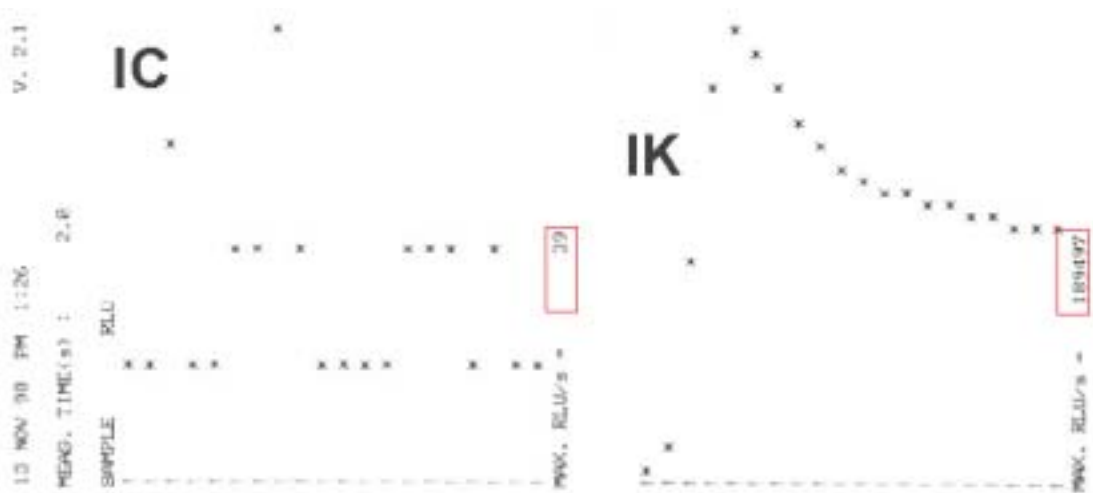
圖二：luciferase 活性的檢測是非常靈敏且具有專一性。IC 植物不含 luc 基因，活性數值為 39 (紅色框)；IK 植物含 luc 基因，活性數值為 189497。每一樣品測定時間為 2 秒，每 0.1 秒讀一次數據並由 * 顯示當時活性，據此 IK 植物之活性在 0.5 秒時達到最高其後遞減。螢火蟲的 luciferase-luciferin 反應均應顯示類似的反應曲線，IC 植物未顯示反應曲線，因此活性數值 39 是無效的，稱為背景值。
